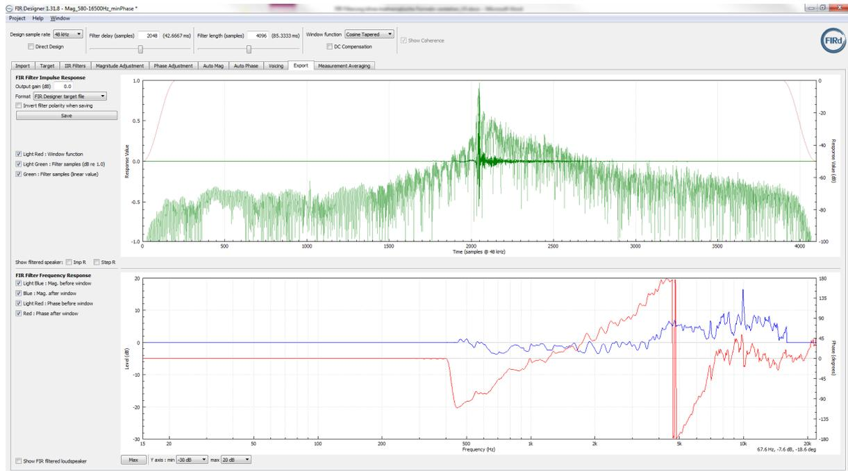
Abbildung 110, Frequenzantwort des FIR-Filters für korrigiertes Hornsystem
