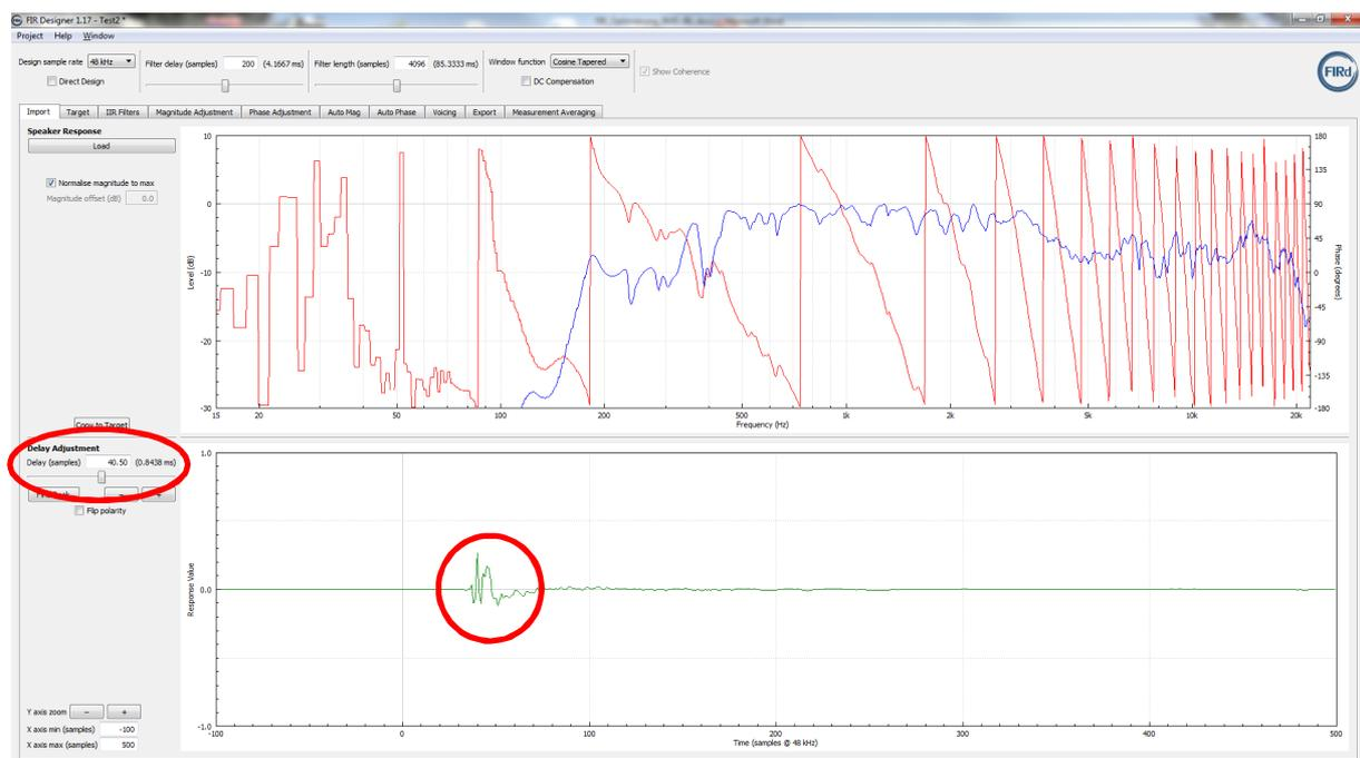
Abbildung 130, Phasendurchgang bei 450Hz Filtereinsatzfrequenz auf  $0^\circ$  mittels Delay gezwungen
