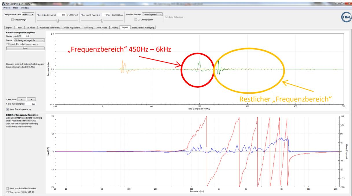
Abbildung 132, Impuls- und Frequenzantwort des FIR-Filters bei reiner Mitteltonkorrektur 450Hz - 6kHz
