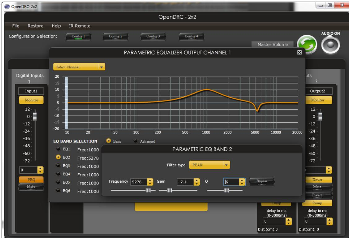
Abbildung 18 , die Möglichkeiten Parametrischer EQs
