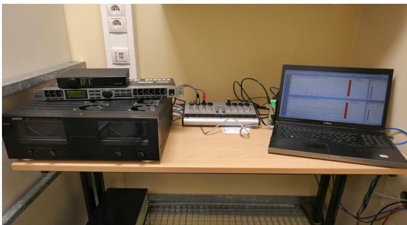
Abbildung 13 : Messaufbau links (OpenDRC, DCX2496, Uher UMA2000), Mitte IO26 als Signalquelle wie Messeinheit, rechts(B&K LAN-XI als Stromquelle für Mikro und Kontrollzwecke sowie Mess-PC für ARTA und Pulse (B&K))
