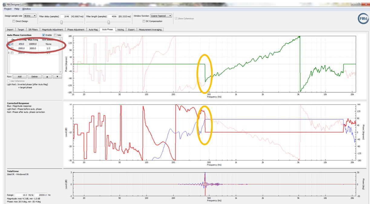
Abbildung 50 , Korrektur der Phase: Bereich 450Hz-16kHz, Sprung der Phase mit starker Korrektur bei Einsatzfrequenz
