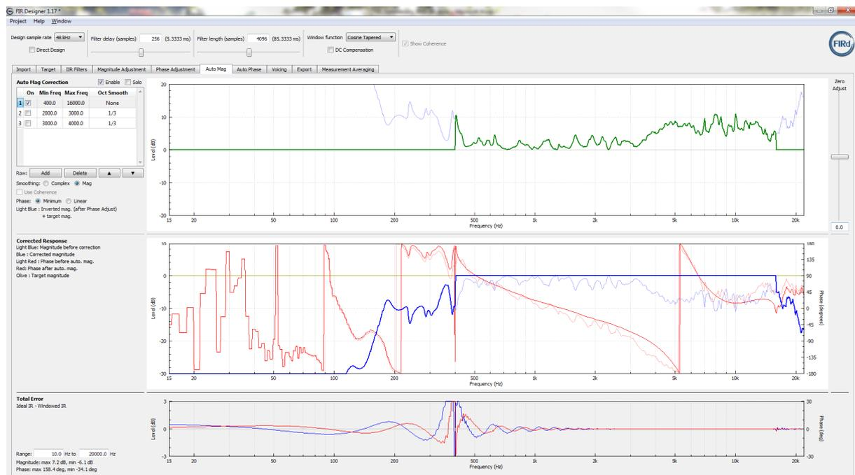
Abbildung 90 , ungeeignete Wahl der Einsatzfrequenz des FIR-Filters mit 400Hz (sowie Korrekturgain)
