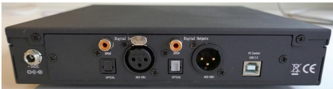
Abbildung 15 , OpneDRC-DI Rückansicht mit fast allem an digitalen Audioanschlüssen (keine Netzwerke)
